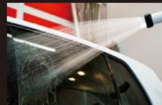
洗車をはじめとした全ての工程で、不純物を99.9%以上取り除いた純水を使用しています。塗装面に不純物が残らないためボディへの負担を軽減し、コーティング剤の密着性が格段に向上します。
