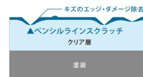
3~5工程におよぶ研磨処理で、塗装の膜厚や状況などを考慮しながらダメージを除去する独自の技法で研磨処理をします。キズなどのダメージが大きい経年車や、塗装面がデリケートな旧車などにおすすめです。アベックスが持つ技術と仕上がりを最も感じていただけるコースです。
