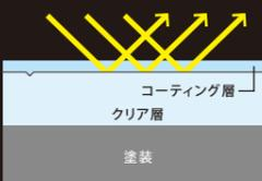
徹底的にボディの下地を整えてからコーティング層を形成する事で、透過した光が下地で反射し美しく光沢が生まれます。またコーティング剤の密着性が高くなり耐久性が向上します。
