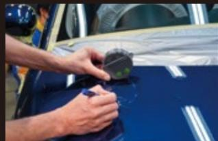
一般的な車両の塗装は平均100ミクロン(コピー用紙1枚分)で、車種や色により塗装の厚みが異なります。アベックスでは適切な磨きを行うため、膜厚計で塗装の厚みを測定し作業を進めます。
