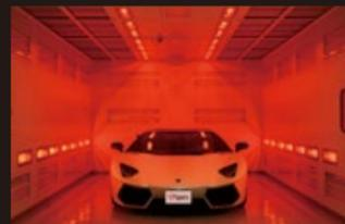
通常コーティング剤が完全乾燥するには2週間~1ヶ月かかりますが、ヒートマスターは約1時間でボディ全体をムラなく完全に乾燥させる事が可能になります。また自然硬化より硬度とツヤが増します。
