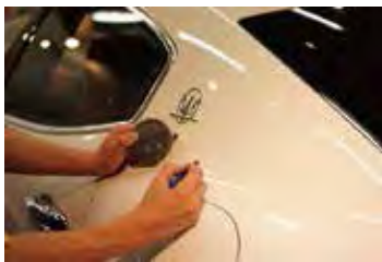
膜厚計による塗装診断
